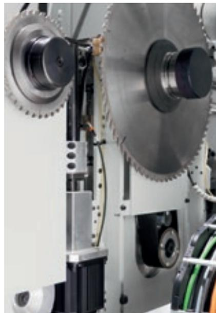
La subida motorizada de las sierras garantiza una regulación precisa y rápida del saliente de la sierra.
